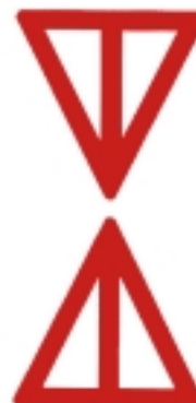
M7 Enslinjemärken för en sjökabels sträckning
