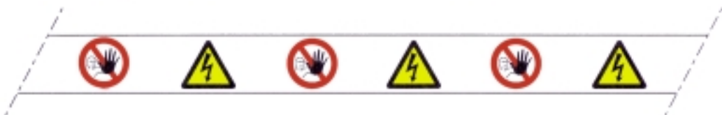
F15 Avspänningsband för tillfällig användning på elarbetsplats där farlig beröring eller åtgärd riskeras. Märkena anbringas på vitt band.
