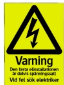
V19 Skylt i anläggning som delvis tagits i drift
