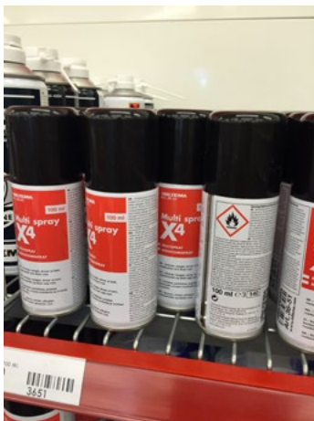
Figur 23. Aerosoler på trådhyllor som effektivt släpper igenom sprinklervatten.
